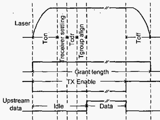
Fig. 2. E-PON timing parameter definitions
