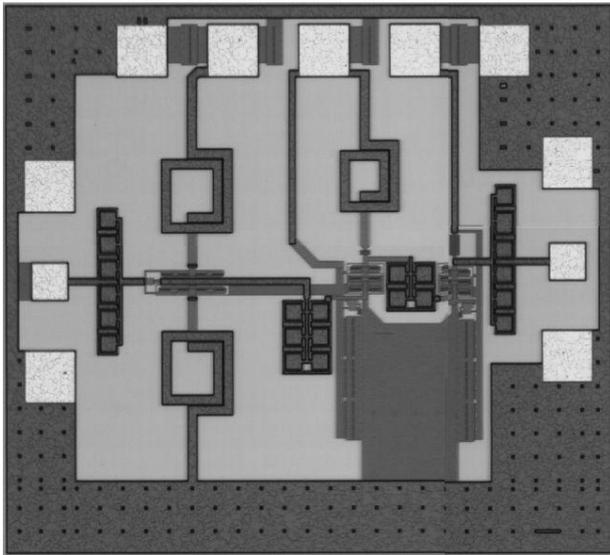
Fig. 4 Chip photograph of LNA ( $1000 \times 870 \mu\text{m}$ )
